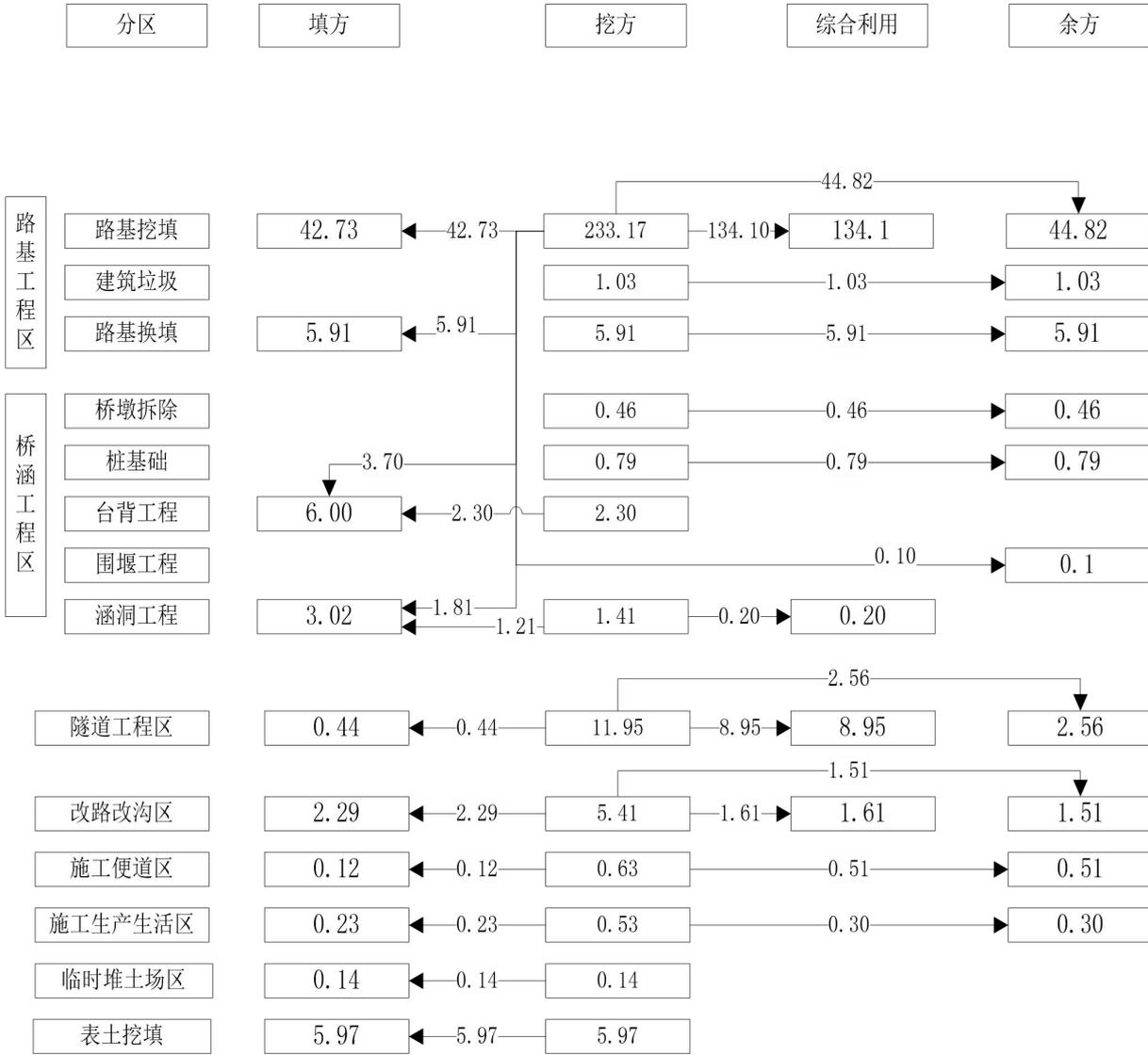
图 3.5-2 项目土石方平衡流向框图 单位：万 m<sup>3</sup>
